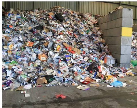
Εικόνα 10: Ενδιάμεση εκφόρτωση σε δάπεδο εντός του Σ.Μ.Α.Υ.
